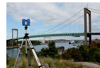
Pont sondé pendant la construction et des contrôles périodiques de la stabilité grâce à la technologie de balayage et de nuage de points à l'aide de la technologie moderne de balayage laser.
