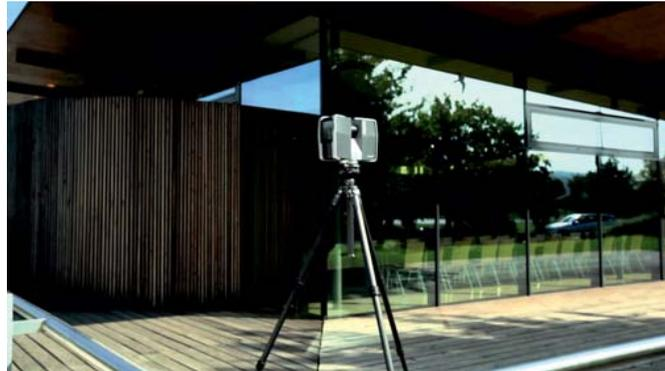
Ideale per acquisire rapidamente precise informazioni sulle condizioni as-built di strutture ed edifici storici, il Laser Scanner genera nuvole di punti delle superfici scansionate utilizzate come base per attività di restauro o conservazione.
