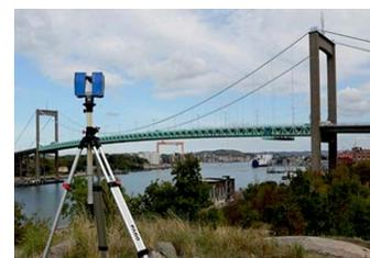
Rilievo di ponte nelle fasi di costruzione e verifiche periodiche di stabilità mediante tecnica di scansione e nuvola di punti utilizzando la moderna tecnologia della scansione laser.
