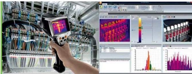
Verifica termica con termo-camera nello spettro infrarosso
